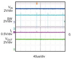
**Steady Waveform** V<sub>IN</sub>=4.4V, V<sub>OUT</sub>=3.3V, I<sub>OUT</sub>=500mA
