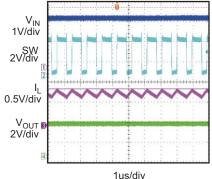
**Steady Waveform** VIN=4.4V, VOUT=3.3V, IOUT=0mA
