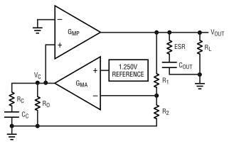
G<sub>MA</sub>: TRANSCONDUCTANCE AMPLIFIER INSIDE IC G<sub>MP</sub>: POWER STAGE TRANSCONDUCTANCE AMPLIFIER
